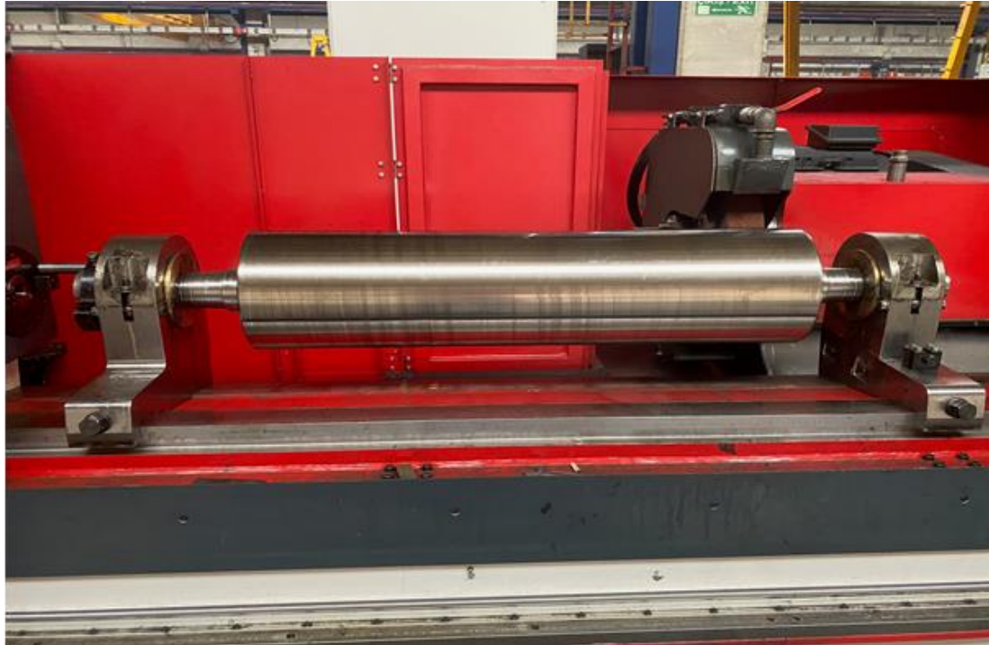
Şekil 3. 4 Hidrolik Sistem Devrede Olmadığı Zaman Mil ve Yatak Arasında Temas Olduğunun Gösterimi
