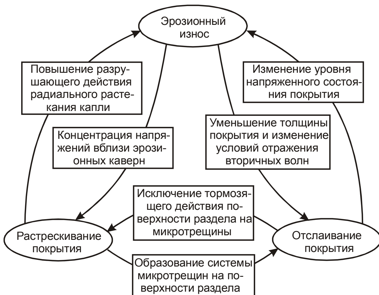
Рис. 195. Граф взаимного влияния механизмов разрушения противозерозионных покрытий
