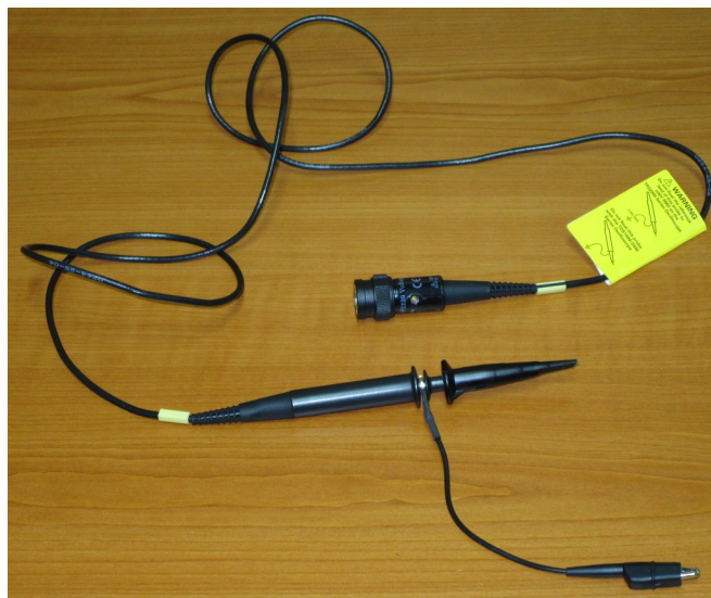
Slika 3.1: Naponska sonda, 1 : 1 i 10 : 1, sa priključkom za masu.
