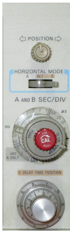
Slika 2.12: Komande za kontrolu vremenske baze osciloskopa.
