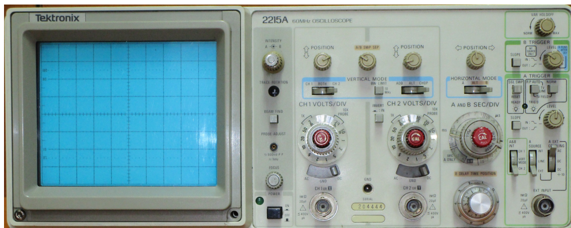
Slika 2.4: Prednja ploča osciloskopa Tektronix 2215A.
