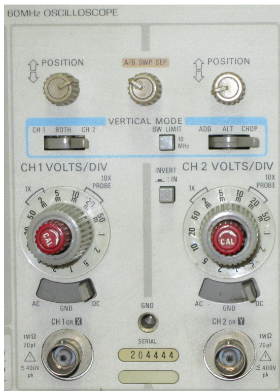
Slika 2.8: Komande za kontrolu pojačavača za vertikalno skretanje mlaza.
