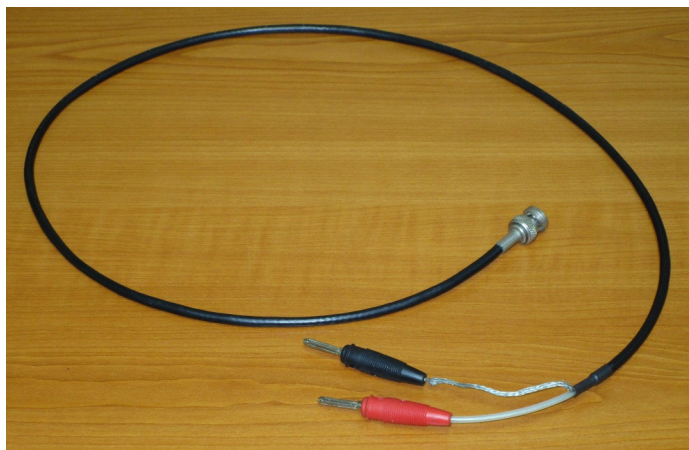
Slika 3.2: Improvizovana naponska sonda 1 : 1 sa priključkom za masu, za laboratorijske vežbe.
