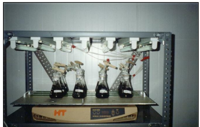
Figura 33 Biorreactores a Escala de Laboratorio
