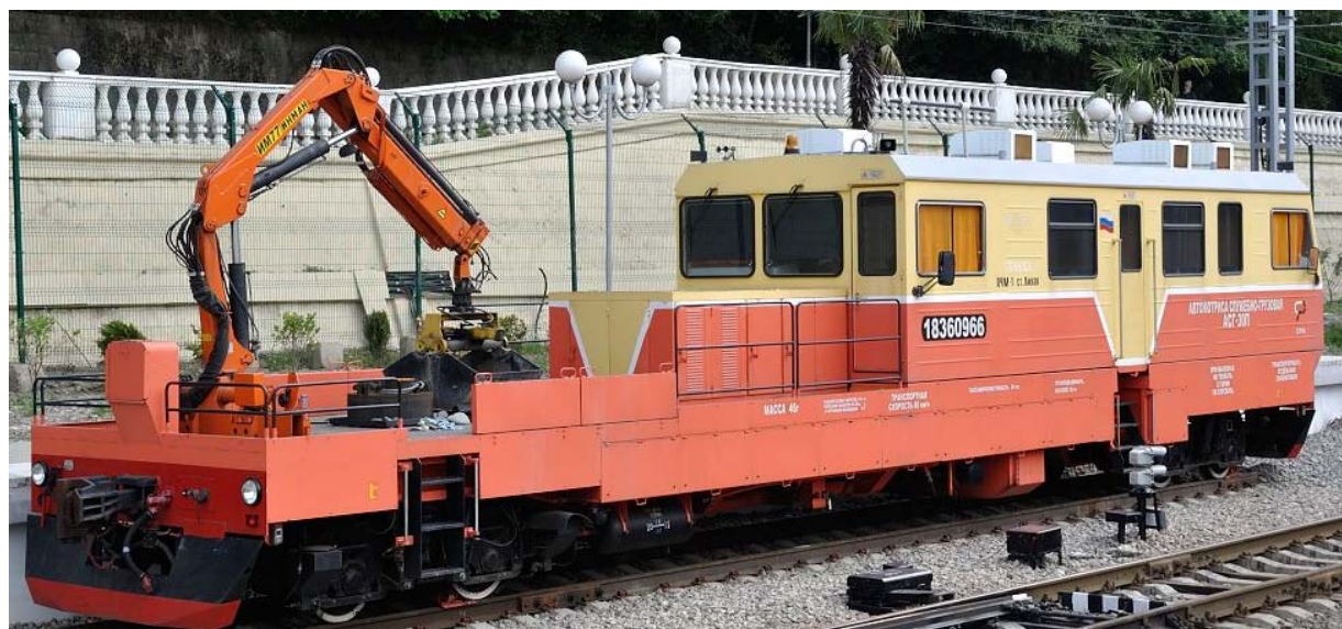
Рис. 15. Автомотриса АСГ-30 с установленным на манипулятор «Имманн» грейферным захватом [108]
