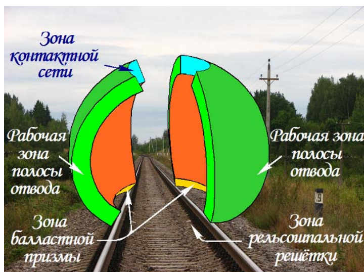
Рис. 12. Сферическое рабочее пространство манипуляторных машин в полосе отвода железных дорог [121]
