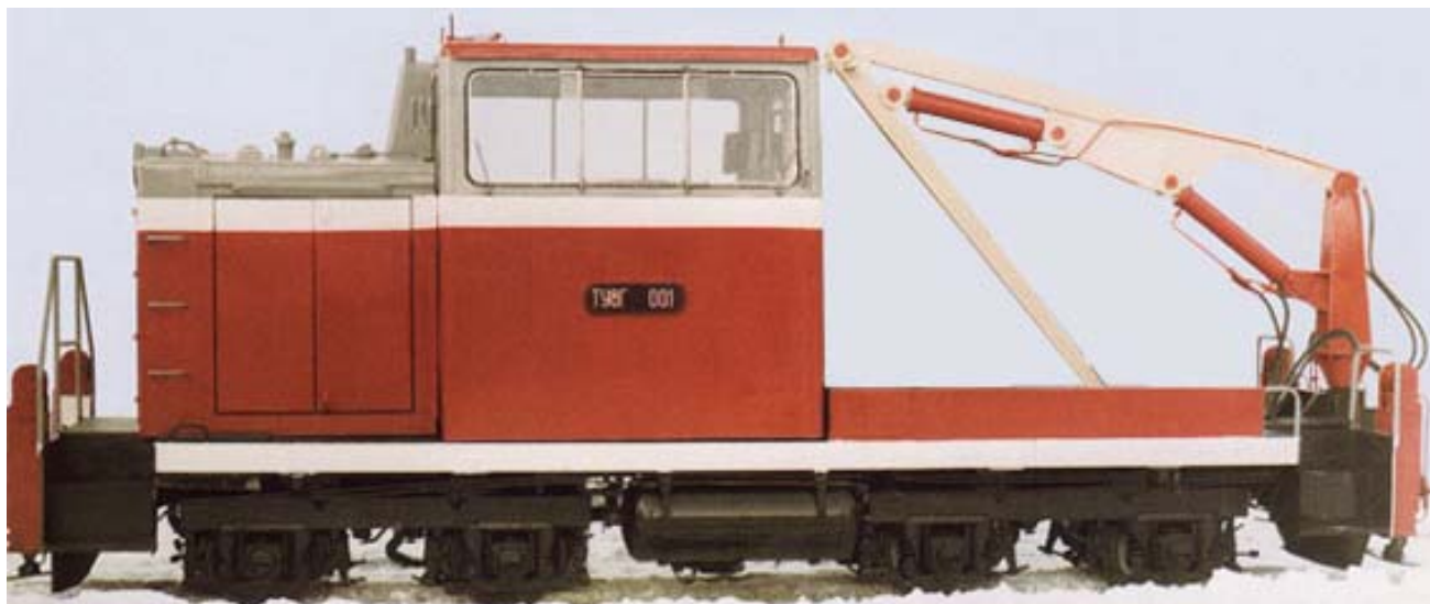
Рис. 19. Дрезина ТУ8Г, оснащенная краном-манипулятором с нестандартной формой звеньев стрелы [143]
