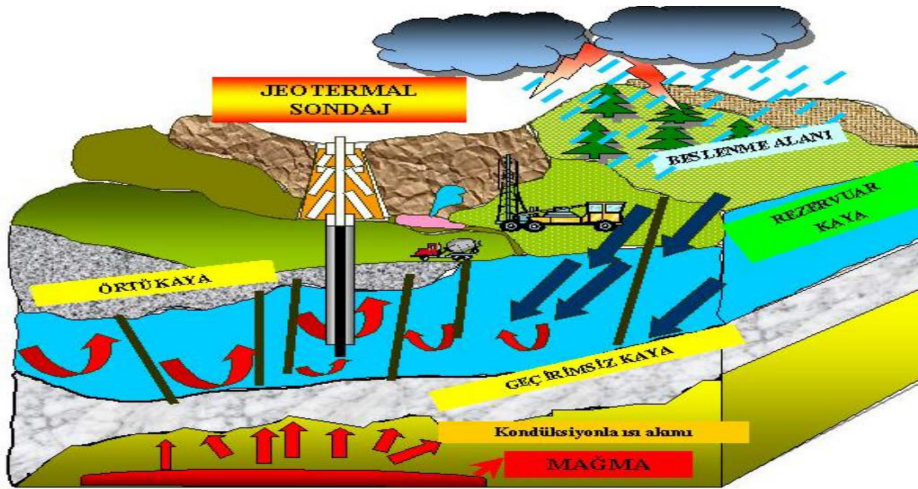
Şekil 1. Jeotermal Sistemin Oluşum Modeli
