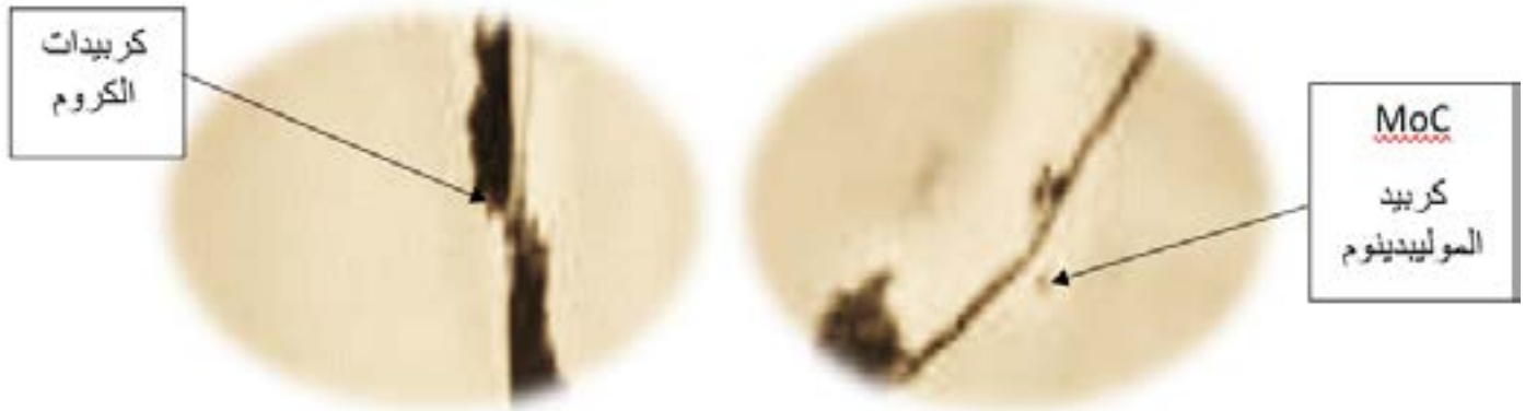
الشكل (٧) البنية المجهرية الناتجة لعينة فولاذ هادفيلد صنف D مع 1.5% Cr-0.9% Mo والتبريد السريع في الماء بعد الصب بنسبة تكبير ٤٠٠ بعد معالجة حرارية حيث نلاحظ تركّز الكريبيدات على حدود الحبيبات مما يؤثر سلباً على الخواص الميكانيكية وهي صفائح مستمرة متتالية بالنسبة لكربيدات الكروم وتكتلات مفردة بالنسبة لكريد الموليبدينوم
