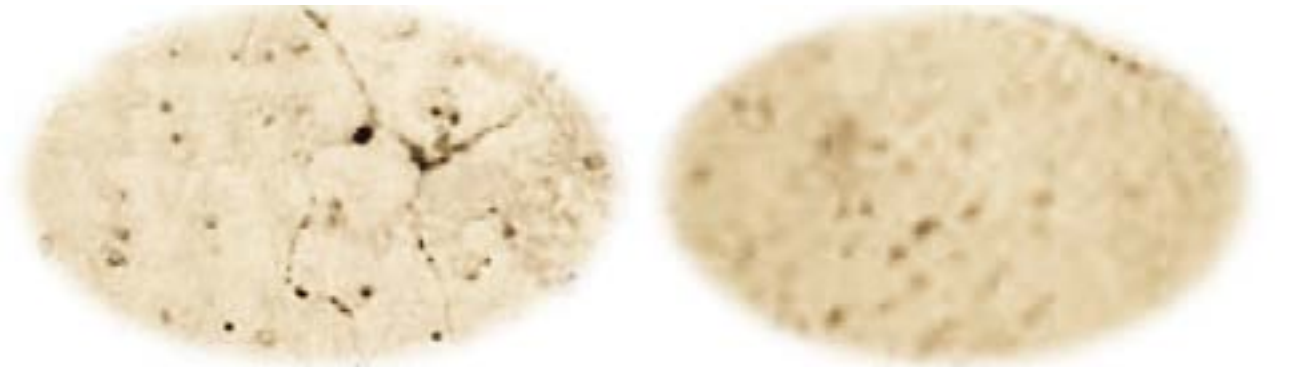
الشكل (٩) البنية المجهرية الناتجة لعينة فولاذ هادفيلد صنف D مع 1.5% Cr-0.9% Mo والتبريد السريع بالماء بعد الصب بنسبة تكبير ٤٠٠ بعد المعالجة الحرارية ٢ حيث نلاحظ أن كمية وحجم الكريبيدات قد قلّ بشكل ملحوظ خاصة عند حدود الحبيبات وهي صفائح مستمرة متتالية بالنسبة لكربيدات الكروم وتكتلات مفردة بالنسبة لكريد الموليبدينوم
