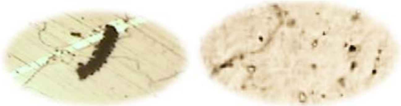
الشكل (٨) البنية المجهرية الناتجة لعينة فولاذ هادفيلد صنف D مع 1.5% Cr-0.9% Mo والتبريد السريع بالماء بعد الصب بنسبة تكبير ٤٠٠ بعد المعالجة الحرارية ١ حيث نلاحظ قلة عدد الكريبيدات ونسبتها على حدود الحبيبات وتوزع أغلبها ضمن الأرضية وهي صفائح مستمرة متتالية بالنسبة لكربيدات الكروم وتكتلات مفردة بالنسبة لكريد الموليبدينوم
