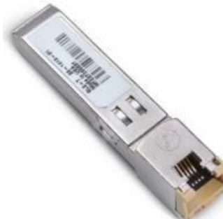
Slika 153. SFP modul: SFP – RJ-45.
