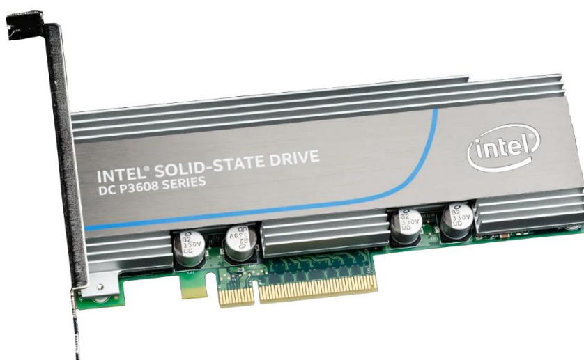
Slika 112.1. Pogled na NVMe disk tvrtke Intel (DC P3608), koji se spaja na PCI Express sabirnicu (x8). Karakteristike 1.6TB NVMe diska: ( Intel DC P3608 )
