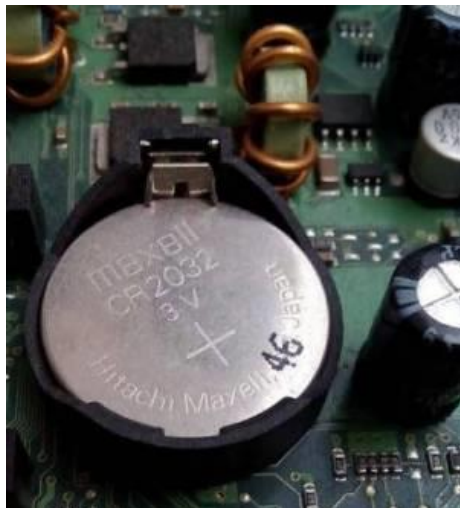
Slika 49. CR2032 baterija na matičnoj ploči
