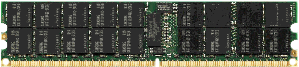
Slika 91. 4GB 240 pinske DDR2-3200 ECC Registered memorije.
