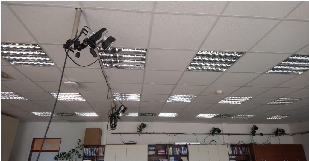
Slika 55, Laboratorija za informacione tehnologije (LaIT) na Elektrotehničkom fakultetu, Univerziteta u Ljubljani – Qualisys 168 optički sistem kamera (eng. motion capture ili mocap ) postavljen na zidovima i plafonu laboratorije. Fotografisano aprila 2024. godine. Uređaj je korišćen u nizu naučnoistraživačkih studija sa ciljem evaluacije drugih senzora [213-215], za biomehaničku procenu tenisera [216] i za druge primene.
