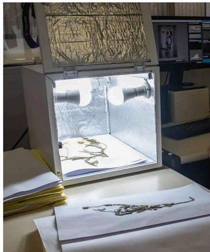
Figura 5. Estação tipo “caixa” com paredes refletoras, ideal para evitar a geração de sombra nas imagens (Herbário HVAT).
