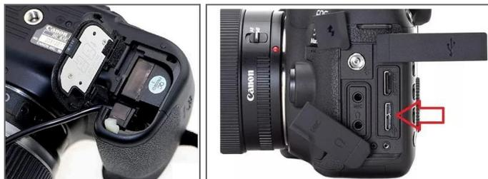
Figura 7. Adaptador de bateria da câmera (à esquerda) e entrada para o cabo que conecta a câmera ao computador (à direita).
