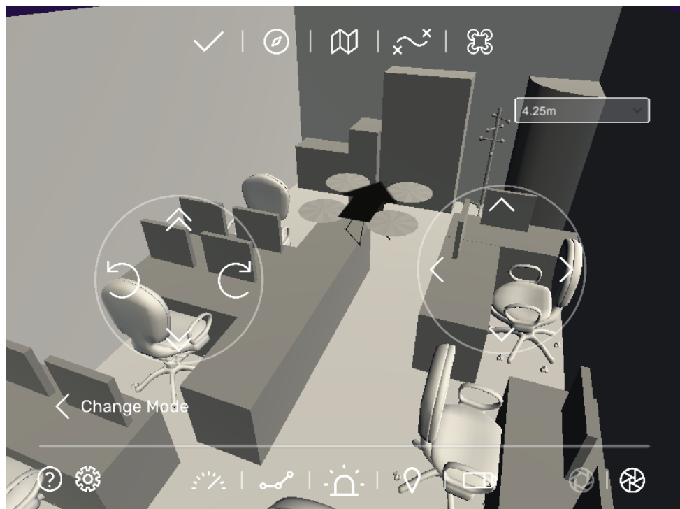
Figura 18. Secuencia de una sesión típica de exploración. Las paredes y el entorno están apareciendo progresivamente en la pantalla mientras el dron se mueve alrededor.
