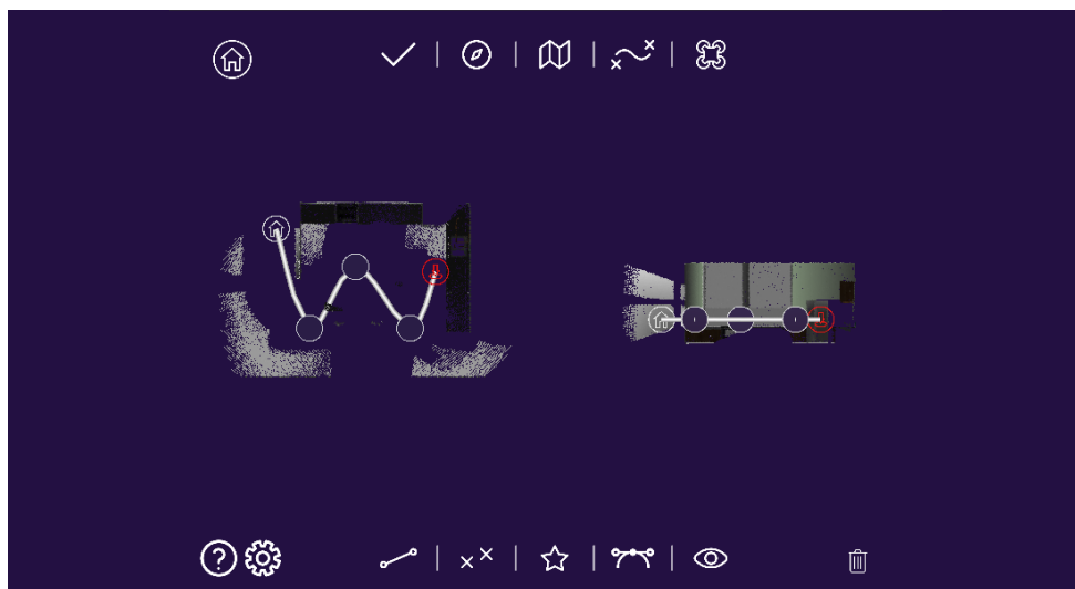
Figura 29. Poner el último punto clave en el mapa del entorno. Éste es el punto de aterrizaje.
