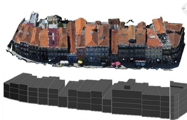
Figura 8: Nuvem de pontos e, modelo de objetos BIM correspondente
