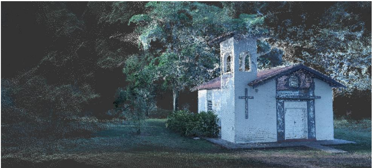
Figura 4: Capela nuvem de pontos no Autodesk Recap® processadas no PIX4D®.
