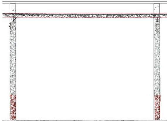
Figura 9: Identificação de deformações no vão da cobertura existente
