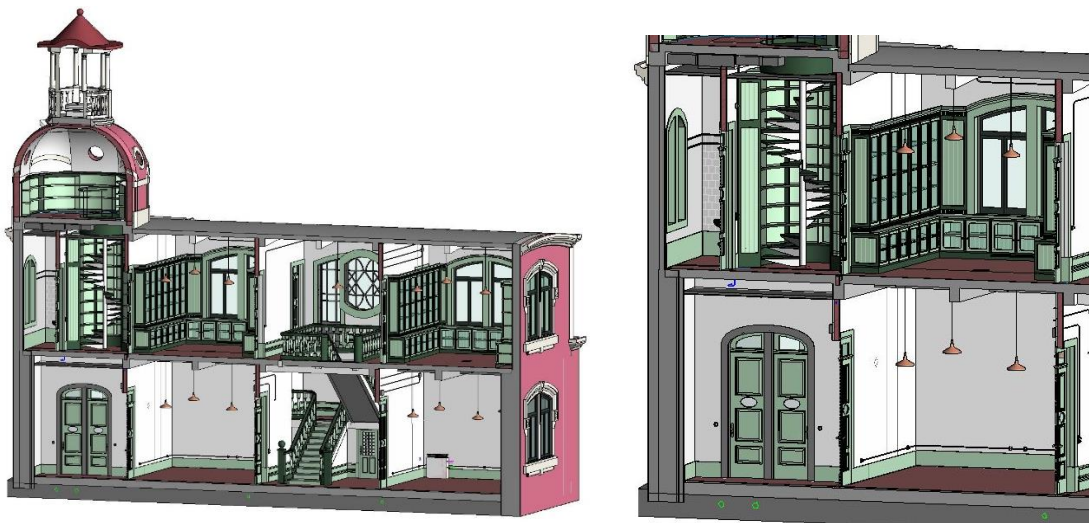
Figura 22: Modelo BIM - Base do Projeto de Execução de onde foram extraídas as Peças Desenhadas e o Mapa de Trabalhos e Quantidades
