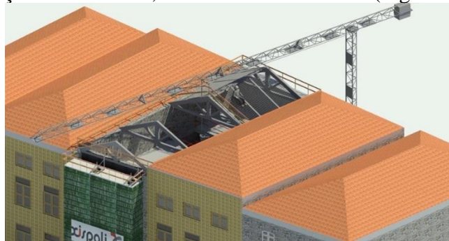
Figura 3: Integração de movimentação de cargas no modelo BIM
