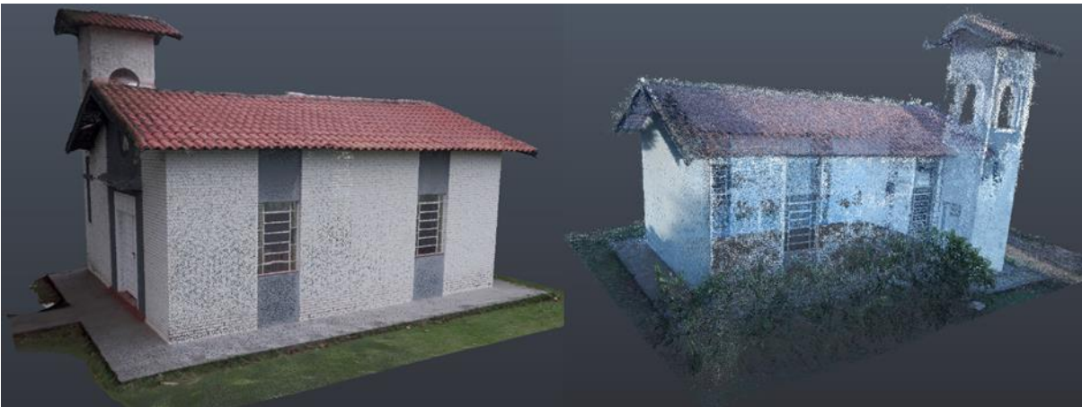
Figura 5: Esquerda: Camera Sony Alpha processada com PIX4D ® no ambiente de visualização do Recap ® . Direita: Camera IPHONE SE processada e visualizada no Recap ® .
