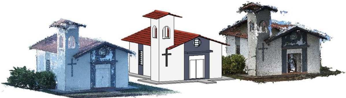
Figura 7: Nuvem de pontos e modelo 3D dentro do Autodesk Revit®.
