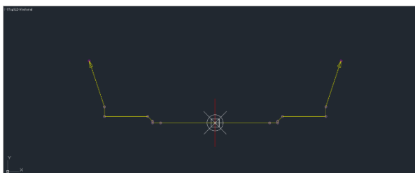
Figura 4: Assembly de escavação
