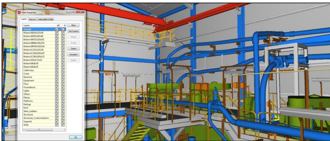
Figura 11 – Exemplo de modelação tridimensional organizada em camadas
