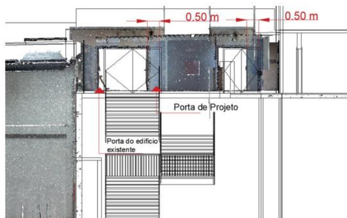
Figura 10: Comparação do alinhamento das portas de emergência da sala do piso superior
