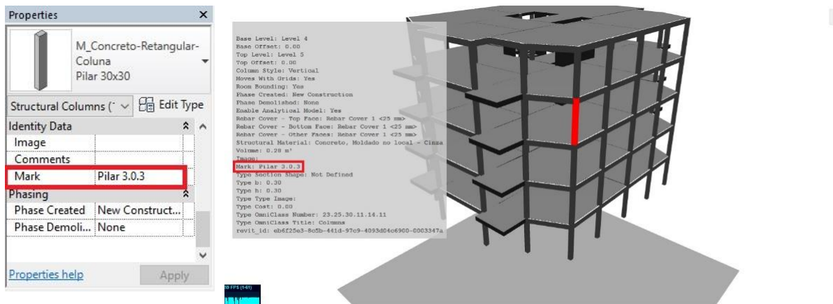
Figura 7 – Marcação dos elementos do Revit para o BIM-CS
