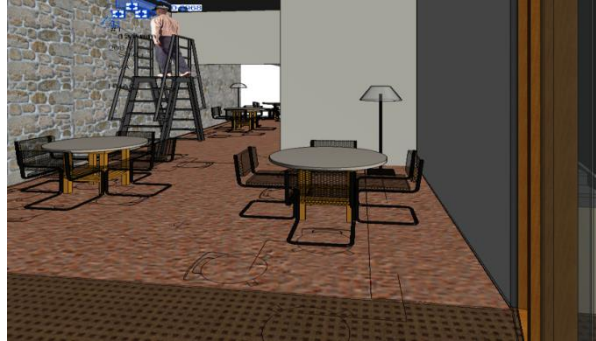
Figura 7: Posicionamento da escada para manutenção do equipamento de ar condicionado
