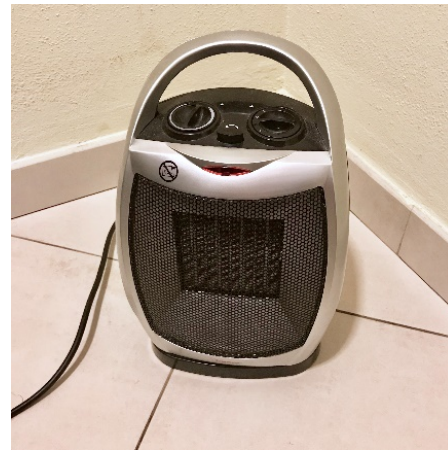
Figura 3: La stufetta elettrica sfrutta l'effetto Joule per produrre calore.
