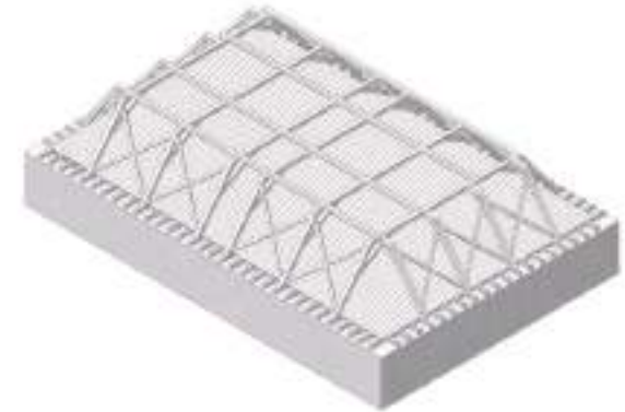
6. Vuoliaisten asettaminen pukkien päälle.
