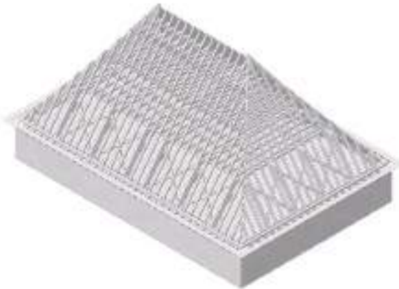
10. Kehäpuu räystäskonsolien ja kääpien päälle, räystäslauditus.
