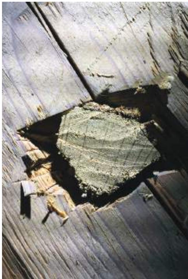
Yllä: Tapin kannassa erottuvat tammen ydinsäteet ja putkiloista koostuva kevätpuu.
