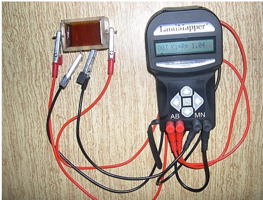
Рисунок 2. Прибор и кювета для измерений электрических свойств в лаборатории
