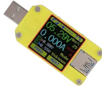
Fig. 4: Dispositivo de medición de resistencia, voltaje y potencia UM34C.
