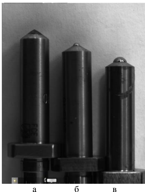
Рис. 2. Инденторы, применяемые в измерении твердости по методу Роквелла: а – алмазный конус, б – шарик \varnothing 1,5875 мм, в – шарик \varnothing 3,175 мм.
