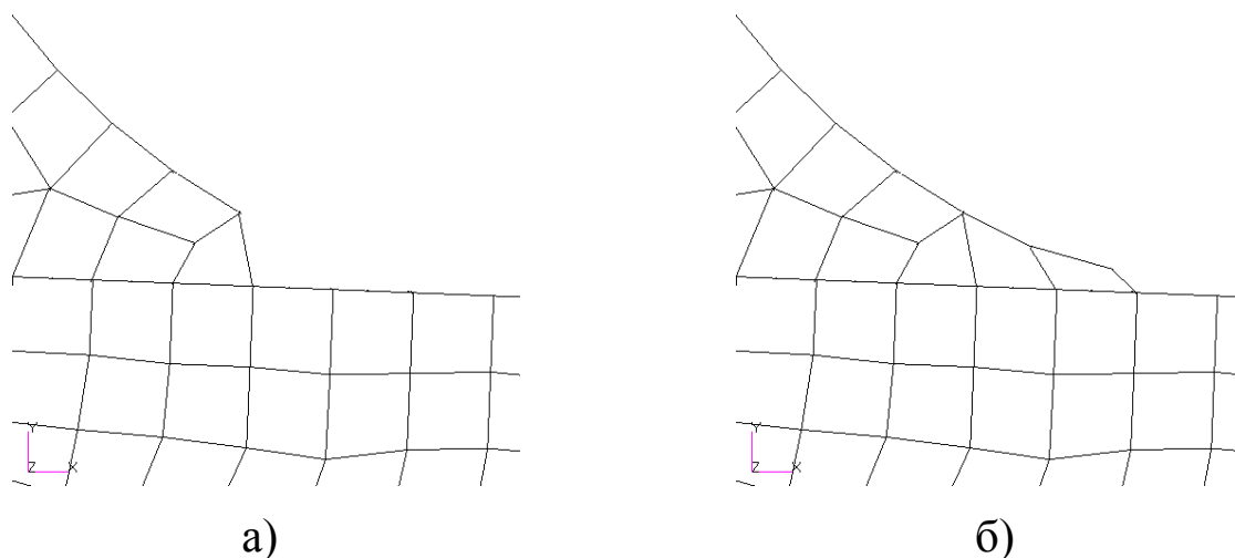
Рис. 1.8. Исправление конечноэлементной сетки: а – вырожденные элементы удалены; б – исправленная сетка
