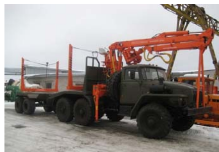
Рис. 8. Автопоезд-сортиментовоз с гидроманипулятором МУГ-70В
