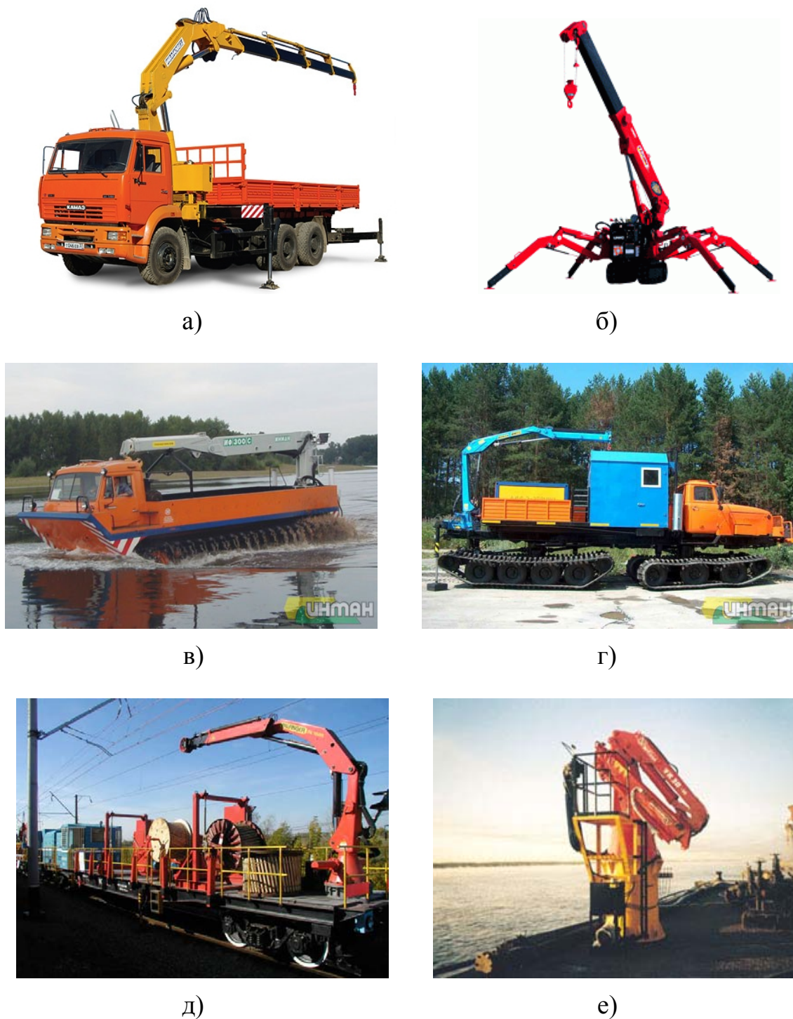
Рис. 3. Базы для установки крана-манипулятора: а – грузовой автомобиль; б – гусеничное шасси; в, г – гусеничная машина; д – железнодорожная техника; е – плавучие средства
