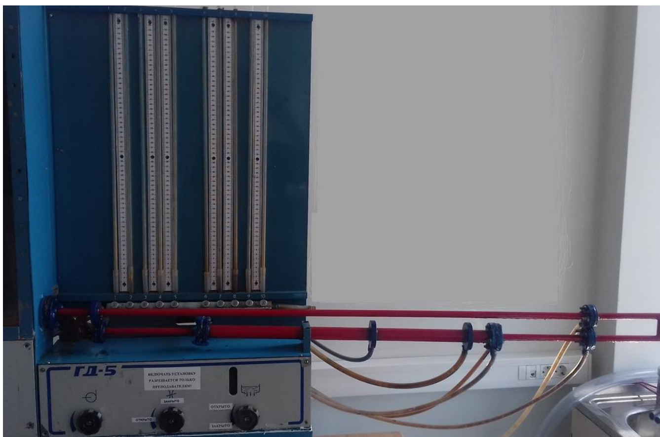
Рис. 1. Экспериментальная установка для определения коэффициента трения \lambda .
