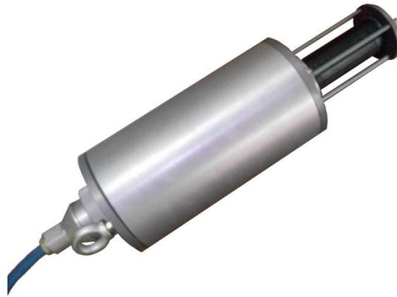
**Рис. 1. Гидроакустический модем собственной разработки, использовавшийся при проведении эксперимента.**
