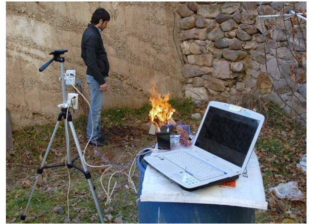
Şekil 3: Algılayıcının görüş menziline sönmek üzere olan bir ateş ve aynı zamanda yürüyen bir insanın olduğu düzenek
