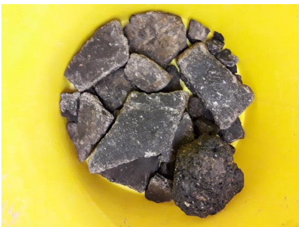
Fig. 29: Bitumen (> 1.7 mm) fraction
