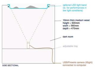
Figure 2. DIRTI hardware schema.
