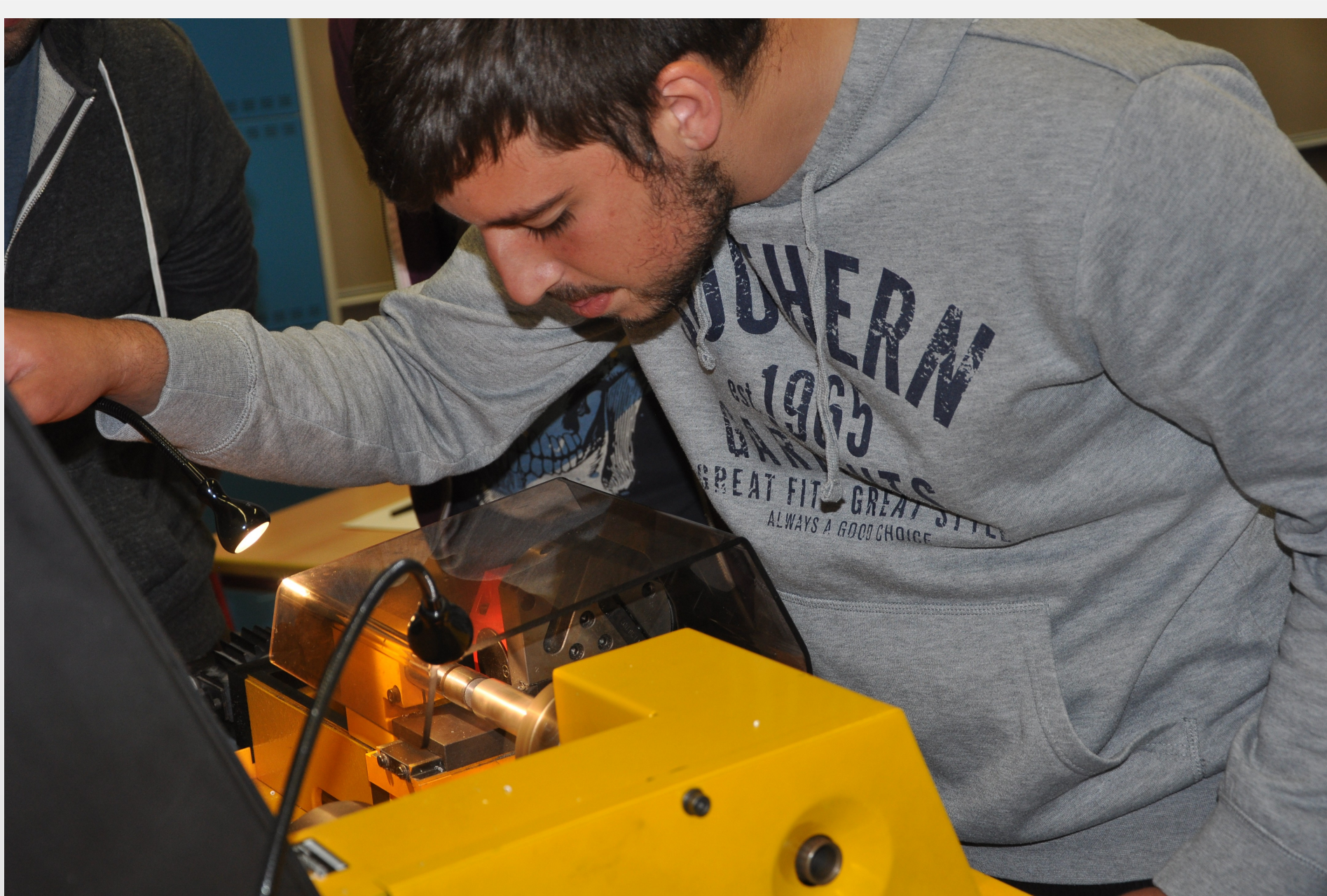
Bild 2: Auszubildende stellen die Werkstück-Proben her: Einrichtung der Drehmaschine
