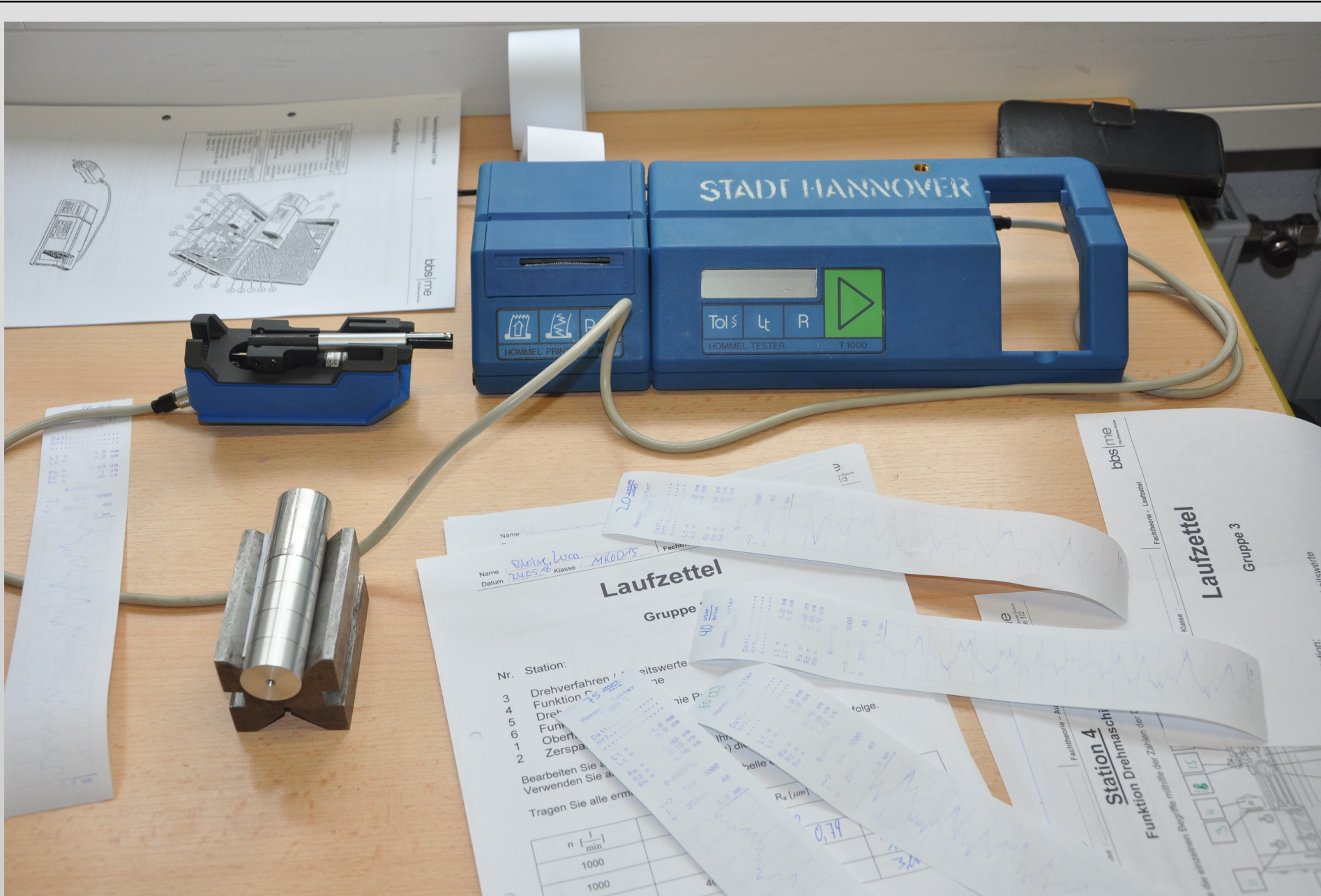
Bild 3: Werkstückprobe, Prisma, Tastschnittgerät und Ausdrücke
