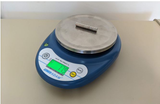
Figura 5. Caracterización del levitador. Proceso de medida de la masa del imán móvil. Para mejorar la precisión se miden varios imanes al mismo tiempo.
