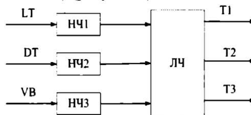
Рисунок 3 - Структура модели Гаммерштейна Нелинейная часть аппроксимирована кубической параболой:
