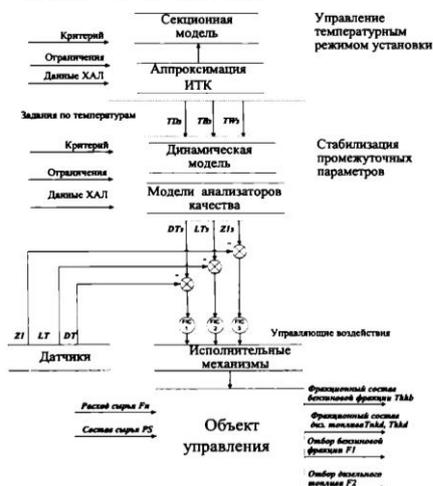
Рисунок 5 - Функционально-структурная схема решения задачи управления
