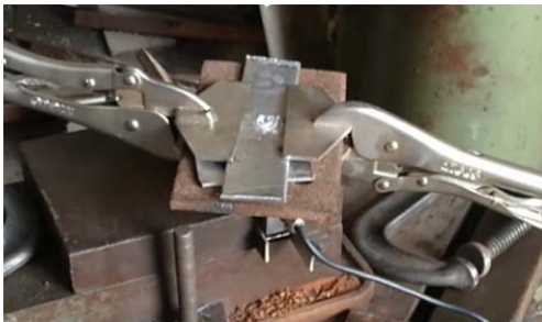
Fig. 4 FSSW specimen fixation
