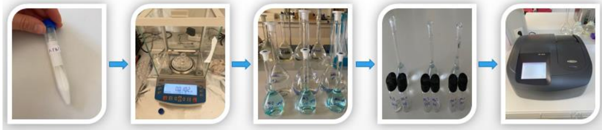
Şekil 2.1.3: APN polimeri UV-VIS absorpsiyon deney basamakları
