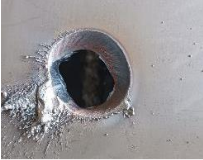
Şekil 3. Hız ve amper ayarının hatalı belirlenmesi
