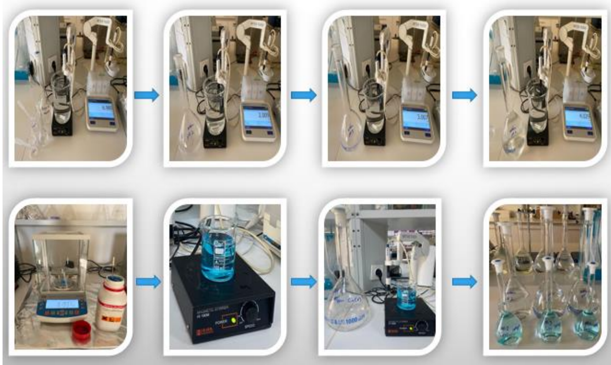
Şekil 2.1.2: Stok çözelti hazırlama aşaması
