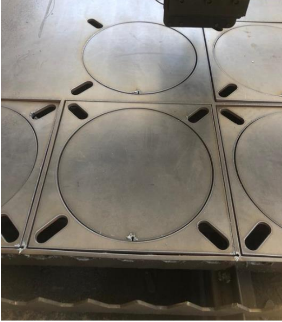
Şekil 7. 5 mm kalınlığındaki St37 malzemenin kesim işlemi
