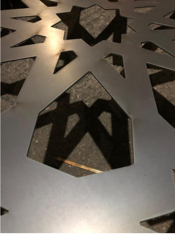
Şekil 5. 2 mm kalınlığındaki St37 malzemenin kesim işlemi
