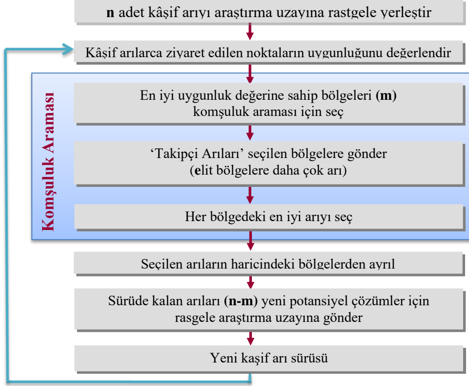
Şekil 1. Arı Algoritması akış şeması
