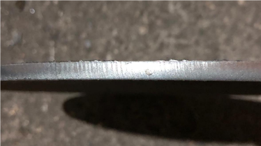
Şekil 8. 6 mm kalınlığındaki St37 malzemenin kesim işlemi
