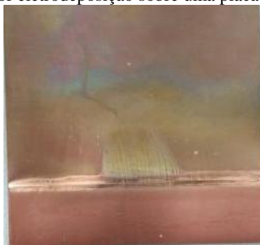
Figura 2: filme de cobre (parte inferior da figura) obtido por eletrodeposição sobre uma placa de cobre.
