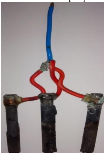
Figura 1: Eletrodo de dióxido de chumbo utilizado como contraeletrodo na deposição de cobre.
