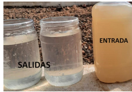
Figura 4. Cambio de coloración de las muestras de entrada y salida del agua en los humedales construidos estudiados
