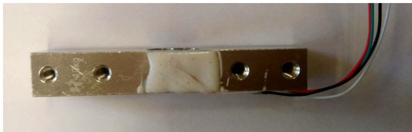
Slika 1: Merne trake koje su postavljene na senzor mase koji može da meri do 10 kg. Za merenje se koristi HX711AD modul (uputstvo je dostupno na https://www.digikey.com/htmldatasheets/production/1836471/0/0/1/hx711.html , pristupljeno 24.03.2024). Fotografisano na Elektrotehničkom fakultetu Univerziteta u Beogradu.
