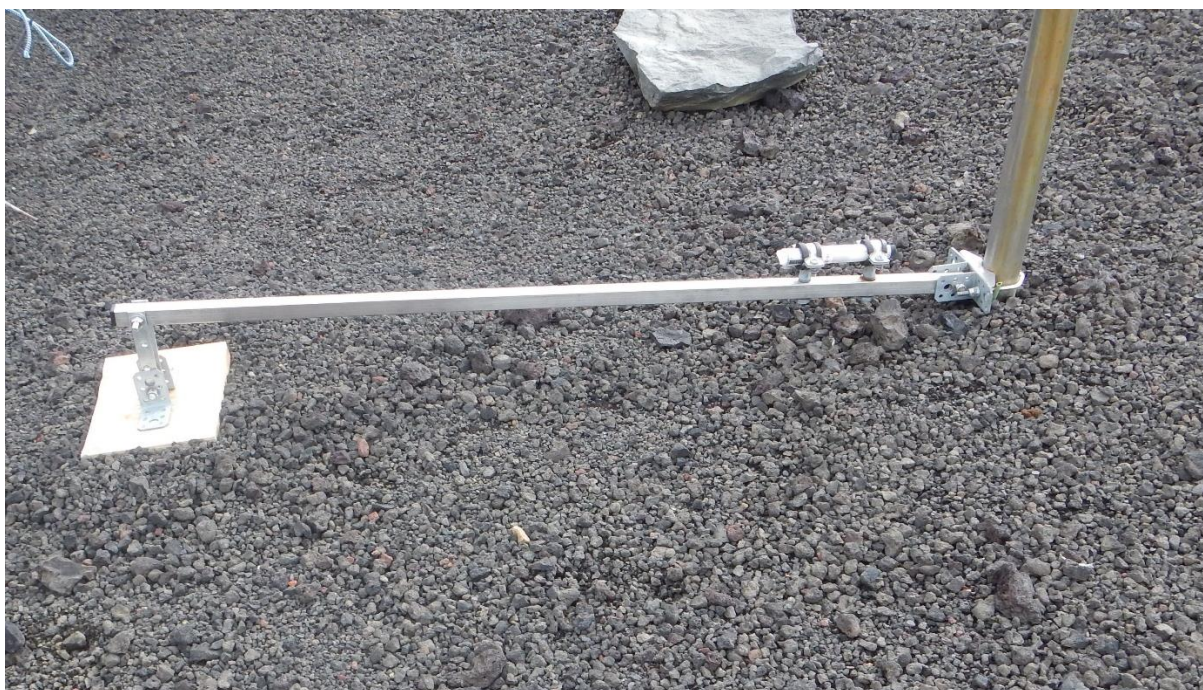
Figura 7: Vista de uno de los instrumentos de construcción artesanal para, con un sensor de inclinación, medir el levantamiento y hundimiento del suelo como consecuencia de los procesos de congelación/descongelación.
