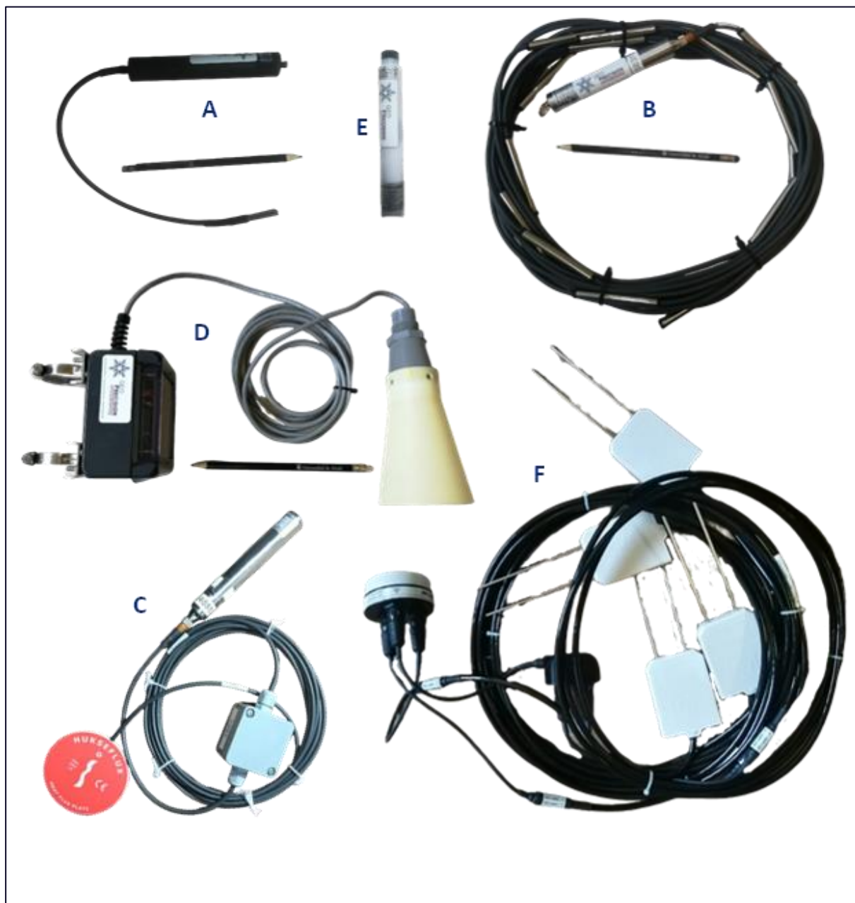
Figura 5: Dispositivos de medida de distintos parámetros en las estaciones PT y CALM de la red PERMATHERMAL en Antártida: [A] Geoprecision Cable (AIR, SUR, TOP); [B] Geoprecision String con cadena termométrica (BOR); [C] Geoprecision String con sensor de flujo térmico (GHF); [D] Geoprecision snowbox (SON); [E] Geoprecision Tilt (GSH); y [F] MicroLog SDI-MP con sensores de humedad del suelo (TDR).
