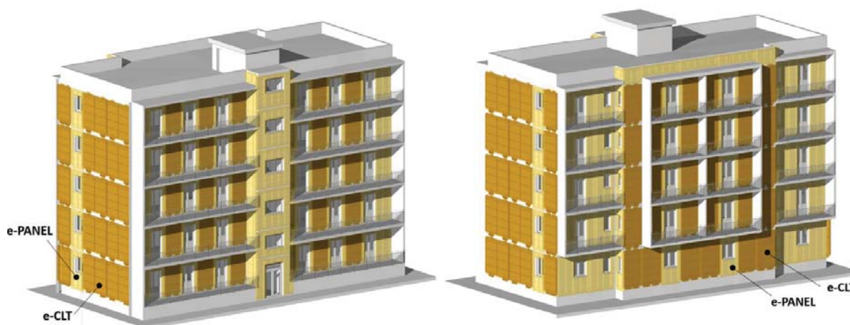
Fig. 5 Distribuzione dei pannelli e-CLT (in arancione) ed e-PANEL (in giallo) secondo il progetto di riqualificazione dell'edificio pilota [7]
