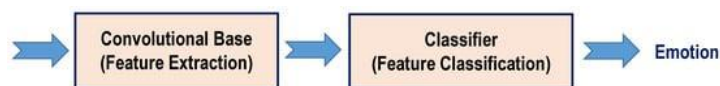
2-rasm. Tuvg'ularni tanib olish uchun transfer o'rganishga asoslangan chuqur CNN modelining umumiy arxitekturasi.
