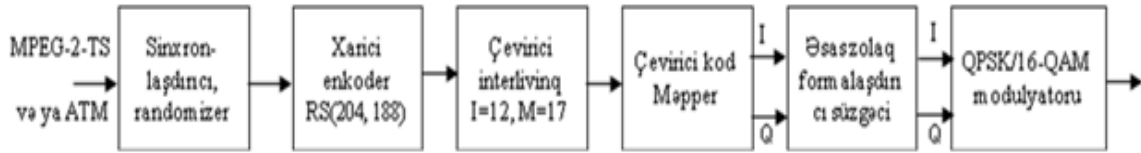
Şəkil 2. Modulyasiya metodunun dəyişməsinə imkan verən LMDS sistemində aşağı axın xətti ötürücüsünün struktur sxemi.
