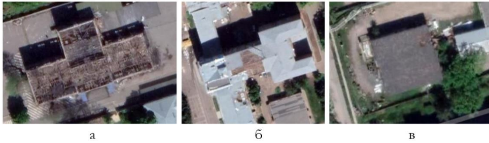
Рисунок 1. Рисунок 1. Візуальна фіксація руйнувань за супутниковими знімками: а – зруйнований об'єкт; б – частково зруйнований об'єкт; можливо зруйнований об'єкт
