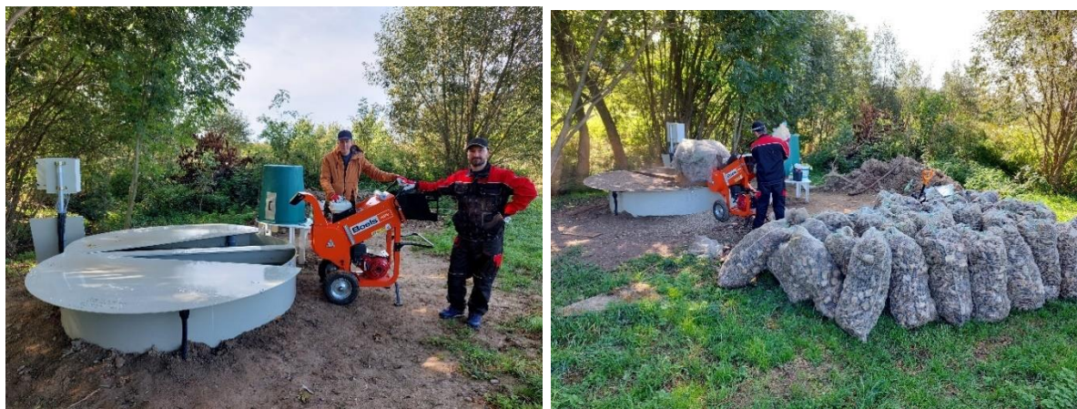
Obr. 22: Dodatečné drcení dřevní štěpky a plnění do bioreaktoru dne 5.10.2023
