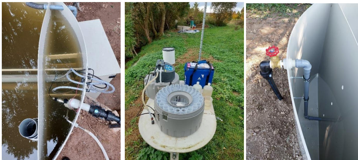
Obr. 21: Testovací naplnění bioreaktoru vodou (vlevo), vnitřní uspořádání vzorkovače ISCO (uprostřed), přívodní potrubí vody do bioreaktoru (vpravo)
