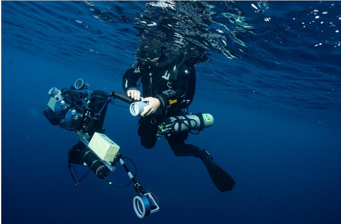
**Fig.2.** Préparation du dispositif Karkam avant l'immersion pour effectuer le relevé photogrammétrique
