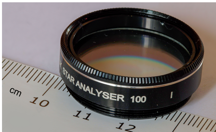
Abbildung 12.7: Durchlass-Gitter-Spektrograph 'Star Analyser 100' [173]. Foto vom Autor.
