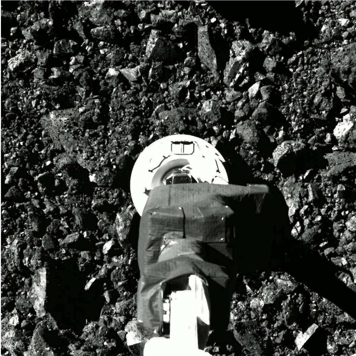
Abbildung 14.4: Saugarm der Raumsonde OSIRIS-REx auf der Oberfläche des Asteroiden (101955) Bennu [113].
