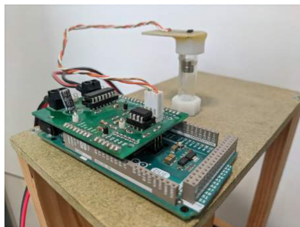
Figura 2: Componentes electrónicos del sistema. La base es la placa de desarrollo Arduino Due. Encima, la PCB que aloja las etapas electrónicas de sensado y de potencia. De fondo se puede ver el imán levitando en el interior del tubo.
