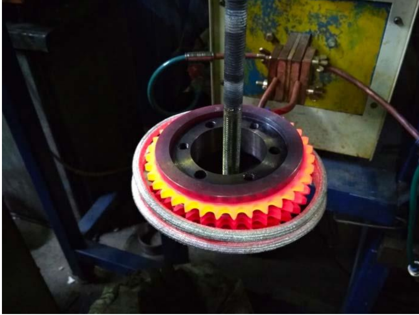
Şəkil 1: Yüksək tezlikli cərəyan ilə dişli çarxın möhkəmliyinin artırılması prosesi.
