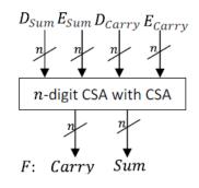
Fig. 8 Modulo  $r^n - 1$  adder
