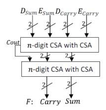
Fig. 9 Modulo  $3^n - 2$  adder
