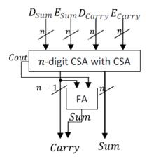
Fig. 10 Modulo  $r^n - 1$  adder where  $r \neq 3$  and  $n \neq 2$
