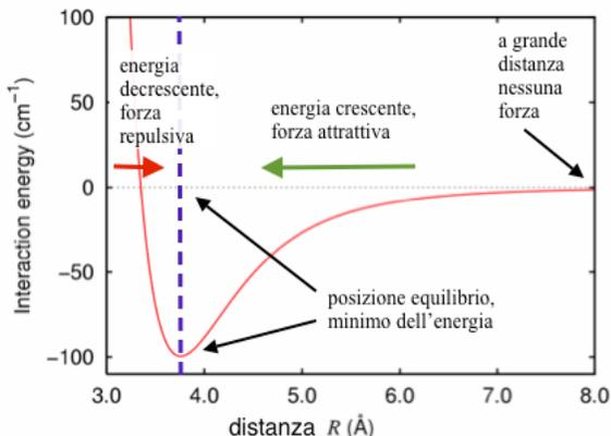
Figura 112. Entità delle forze di van der Waals al variare della distanza intermolecolare, secondo il modello di Lennard-Jones.<sup>183</sup>
