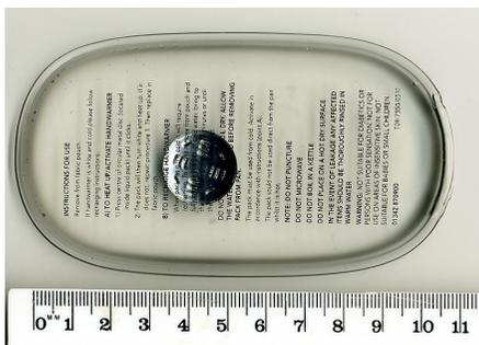
Figura 126. Scaldamani all'acetato di sodio.<sup>195</sup>
