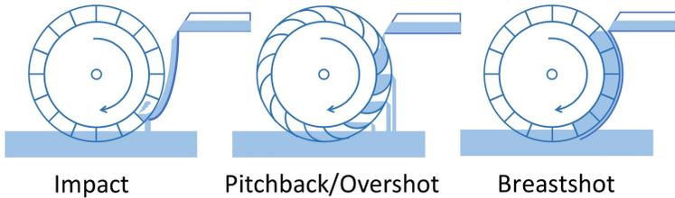
Figura 137. Diversi tipi di ruote idrauliche.
