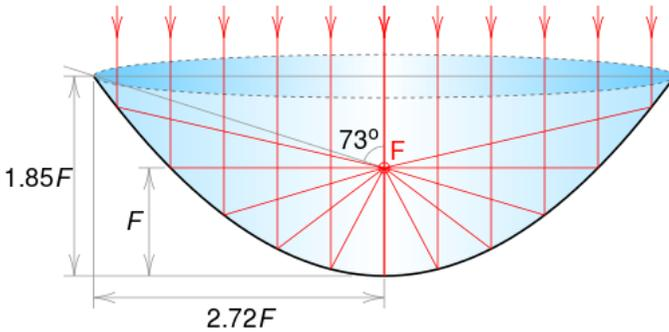
Figura 150. Specchio parabolico.<sup>258</sup>
