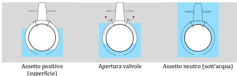
Figura 60. Assetto di un sottomarino.<sup>112</sup>
