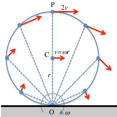
Figura 28. Velocità delle diverse parti della ruota nel rotolamento puro.
