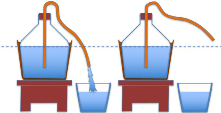
*Figura 81. Travasamento di un liquido mediante sifone.*
