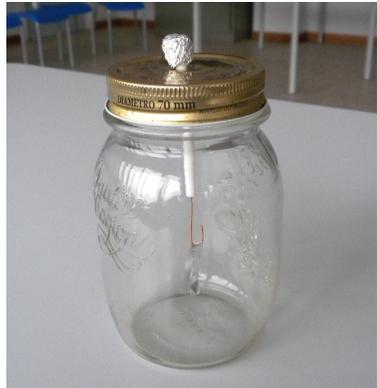
Figura 128. Elettroscopio casalingo.
