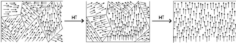
*Figura 158. Orientazione e incremento delle dimensioni dei domini magnetici in conseguenza dell'applicazione di un campo magnetico esterno.<sup>284</sup>*
