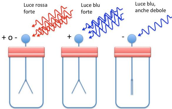
Figura 131. Verifica dell'effetto fotoelettrico con un elettroscopio.
