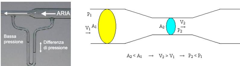
Figura 95. Funzionamento di un venturimetro.<sup>152</sup>
