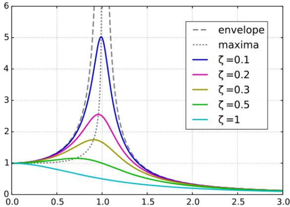
Figura 147. Ampiezza delle oscillazioni di un oscillatore armonico in funzione del rapporto tra frequenza forzante e frequenza di risonanza per vari valori dello smorzamento ( $\zeta$ ).<sup>249</sup>
