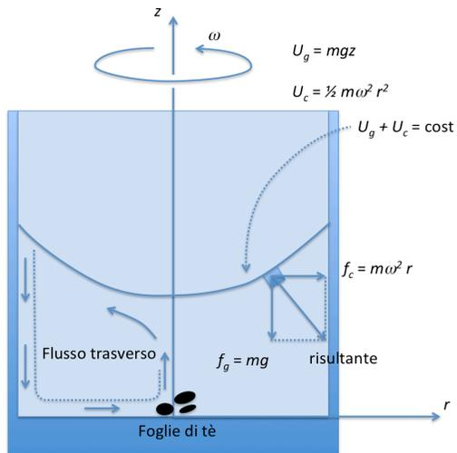
Figura 10. Schema delle forze, delle energie potenziali e del flusso trasverso per un vaso fermo contenente acqua in rotazione.
