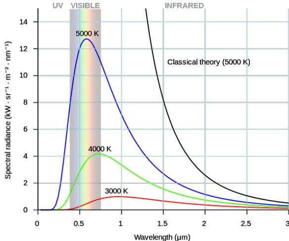
Figura 144. Intensità di emissione del corpo nero in funzione della lunghezza d'onda per varie temperature (assolute). Viene riportata anche la curva secondo l'elettromagnetismo classico e la "finestra" del visibile.<sup>245</sup>
