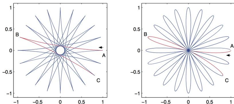
Figura 49. Traiettorie del pendolo di Foucault partendo con velocità nulla da una certa deviazione (a sinistra) e dalla posizione di riposo con una certa velocità radiale (a destra).<sup>93</sup>
