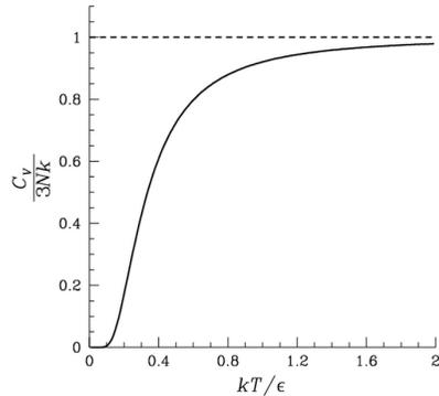
Figura 141. Andamento del calore specifico di un solido di Einstein con la temperatura.<sup>241</sup>
