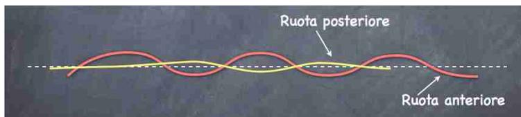
*Figura 40. Oscillazione delle ruote della bicicletta.*
