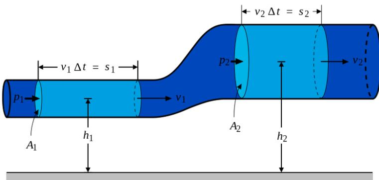
Figura 92. Derivazione dell'equazione di Bernoulli.<sup>148</sup>
