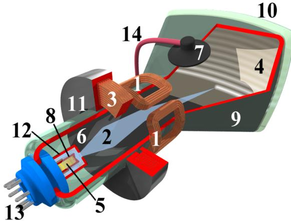
Figura 130. Sezione schematica di un tubo a raggi catodici.<sup>208</sup>
