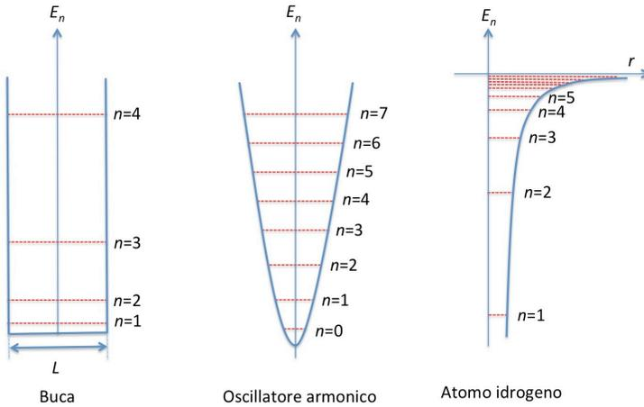
Figura 134. Spettri energetici della buca “quadrata” (pozzo), dell’oscillatore armonico e dell’atomo di idrogeno.
