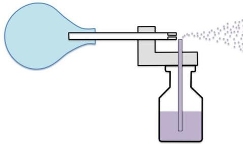
Figura 94. Schema di funzionamento di uno spruzzatore.
