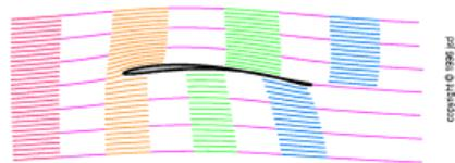
Figura 105. Deflessione dell'aria da parte di un'ala curva.<sup>166</sup>
