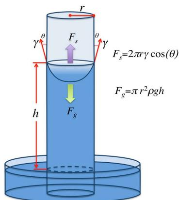
Figura 76. Schema delle forze in un capillare.
