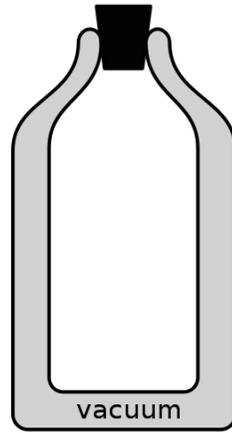
Figura 152. Sezione di un vaso Dewar.<sup>265</sup>
