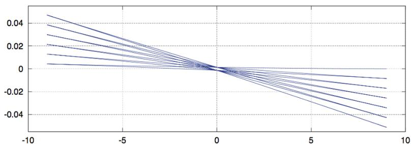
*Figura 50. Ricostruzione della traiettoria descritta dal pendolo di Foucault (lunghezza 88,7 m) installato nel Duomo di Firenze il 19/6/2008. Le dimensioni sono in metri, il periodo di oscillazione è di 20 secondi.<sup>95</sup>*
