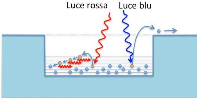
Figura 132. Fotoni ed effetto fotoelettrico.
