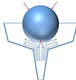
Figura 98. Paradosso idrodinamico: è impossibile soffiare via la pallina.
