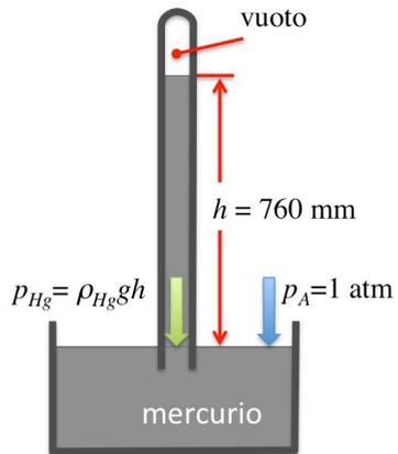
Figura 78. Barometro di Torricelli.
