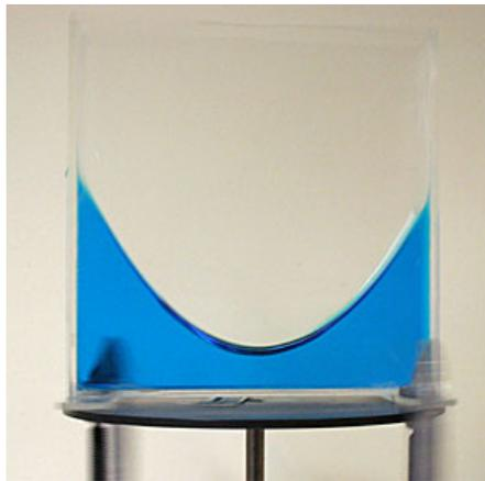
*Figura 9. Forma parabolica del pelo dell'acqua.<sup>22</sup>*
