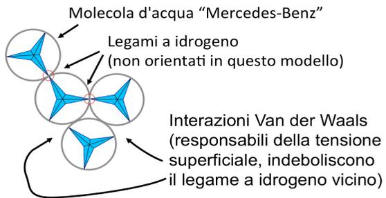
Figura 118. Funzionamento del modello Mercedes-Benz.
