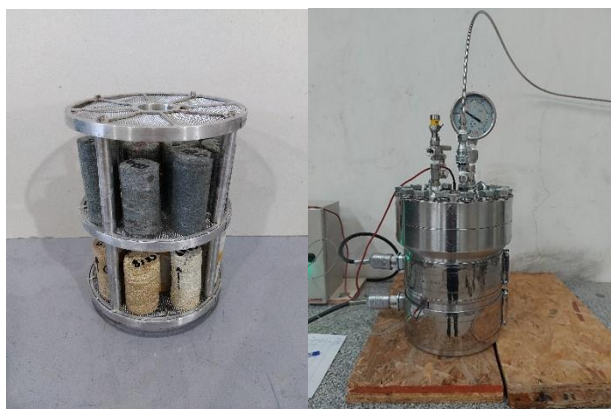
Figura 1. Distribución de las probetas de arenisca del Banco Verde en el porta-muestras y celda de carbonatación utilizada para la inyección de scCO 2 en las probetas.
