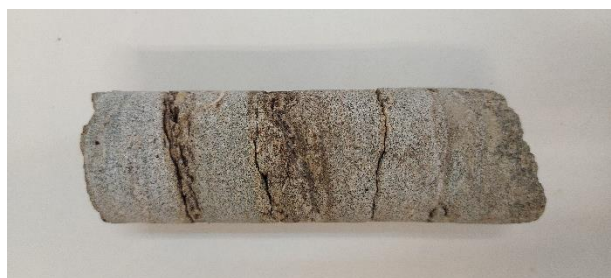
Figura 2. Probeta fisurada con discontinuidades horizontales.
