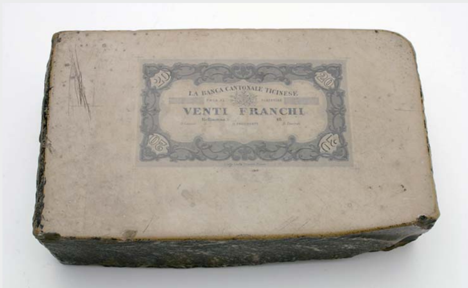
5 | 28 Pietra litografica incisa di fine Ottocento utilizzata come calco per banconote da venti franchi della Banca Cantonale Ticinese. (Fototeca CDE, BEL-1989.0014.0035)
