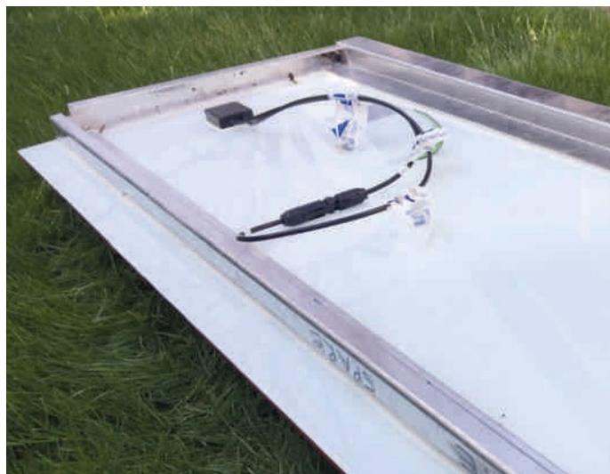
Die rückseitig aufgeklebten, keilförmigen Aluminiumrahmen mit den Langlöchern an den Seiten zur Aufnahme der bauseits angebrachten Haltehaken
