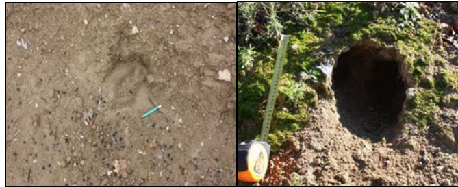
FIGURE 6. À gauche, tentative avortée de creusement d'un terrier dans le sol-chaux. À droite tentative réussie dans le même sol non traité (Photos S. Nicaise - 2021) [8].
