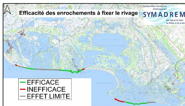
FIGURE 4. Efficacité des enrochements.
