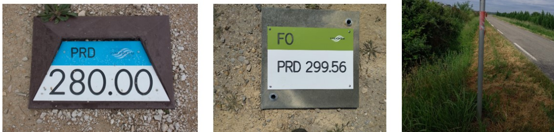
FIGURE 2. Borne repère - plaque de réseaux traversants - panneau de signalisation.
